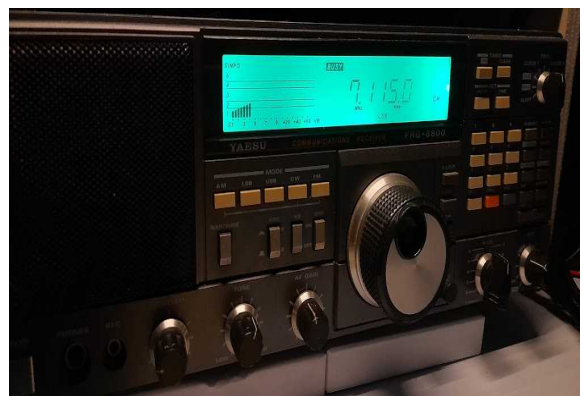
Rumore di fondo in 40 metri con D.E.A P.Amp sotto antenna acceso. Si noti lo S-METER a S4
