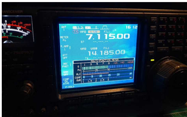
Rumore di fondo in 40 metri con verticale caricata sul terrazzo – P.Amp su 1 inserito Quasi S9 – senza P. Amp inserito, S7!
