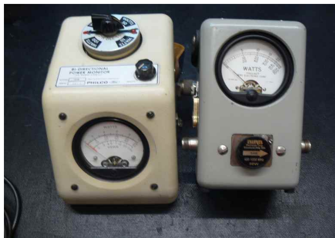
I wattmetri usati, il classico Bird 43 e lo Struthers 102A
